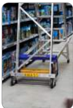
Base estabilizadora más estrecha: 75 cm
