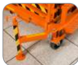
Los estabilizadores se pueden colocar en distintas posiciones para mayor estabilidad
