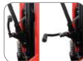
Pedal de elevación abatible
