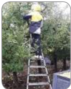
Su forma cónica facilita el acceso entre las ramas de los árboles
