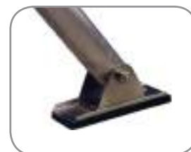
Estabilizadores equipados con zapatas basculantes
